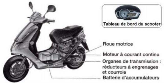
Le microcontrôleur envoie alors un ordre (via un **câble électrique**) au **modulateur d'énergie** qui **distribue** la quantité d'énergie nécessaire au moteur à courant continu. Un capteur de vitesse monté sur la roue avant acquiert à tout moment la vitesse à laquelle roule le scooter et envoie cette information au microcontrôleur.
