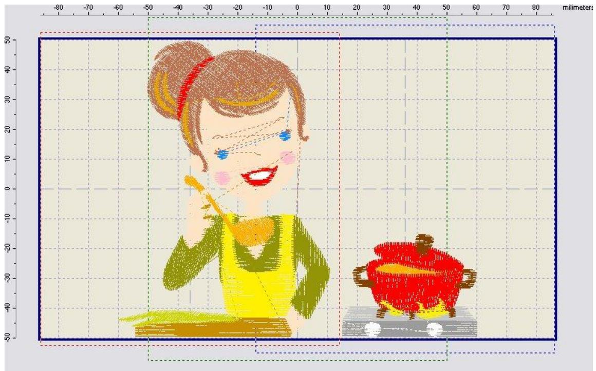
Je peux voir que ce cadre a les indications des ses 3 positions d'ancrage, la partie gauche, qui est matérialisée en pointillés rouges, la partie centrale qui est
