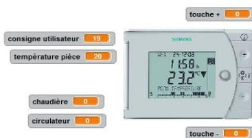
Le régulateur hebdomadaire est une interface entre l'utilisateur et le système automatique de régulation de la température. Quand l'utilisateur appuie sur la touche la variable , sinon . De la même manière, quand l'utilisateur appuie sur la touche , la variable , sinon . Les commandes et éteignent et allument la chaudière respectivement.
