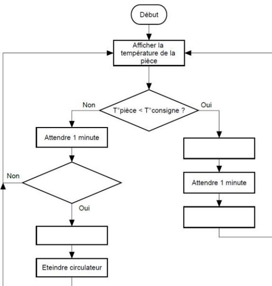
Le régulateur teste la température de la pièce et la compare avec la température de consigne définie par l'utilisateur.
