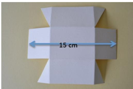
Couper un rectangle de 15 x 13 cm. Sur le côté mesurant 15 cm, marquer un pli à 4 et 11 cm du bord. Sur le côté mesurant 13 cm, marquer un pli à 4 et 9 cm du bord. Couper les languettes en respectant la photo ci-dessus.
