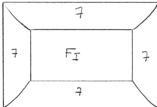
Calcul :  $\text{marge} \times 2 + \text{FI} = \text{mesures totales}$ .
