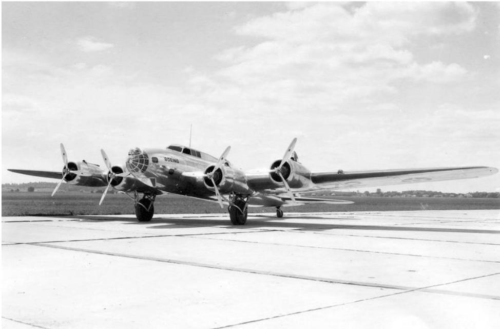
Le Model 299 était alors le premier Bombardier de construction métallique, quadrimoteur monoplane. Les essais de roulage furent faits dans les jours suivants, il fut découvert que la queue de l'appareil rebondissait au roulage à haute vitesse. Le 28 juillet suivant l'avion fit son premier vol (*ci-contre*), un an après le début de sa construction, Leslie R.
